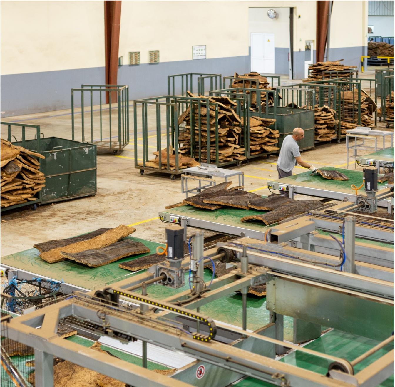
Linhas automatizadas de escolha de matéria-prima que recorrem a um sofisticado mapeamento das pranchas de cortiça através de robotização, leitura laser, inteligência artificial, *machine learning* e visão ótica.
