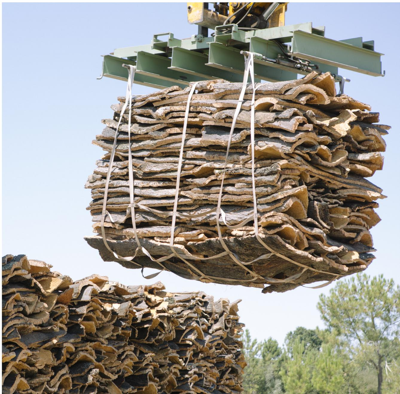
A Corticeira Amorim está a desenvolver ferramentas de carga mecanizadas com recurso a instrumentos que permitam retirar a intervenção humana no carregamento das prnchas de cortiça.
