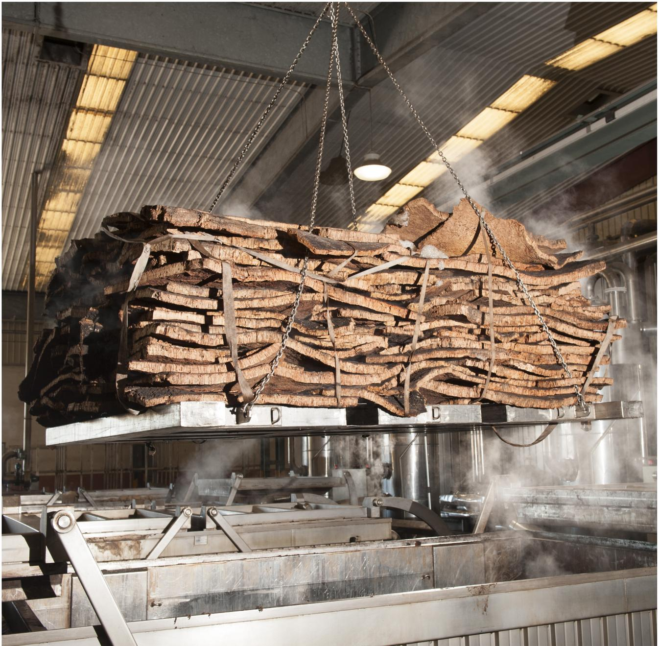
À primeira seleção de cortiça segue-se um processo de cozedura. As pranchas de cortiça são cozidas em tanques de aço inoxidável fechados e filtrados. O objetivo é permitir sobretudo que a cortiça atinja o teor de humidade correto para ser processada.
