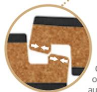
Quando a placa é inserida na junta, o núcleo em cortiça comprime-se automaticamente.
