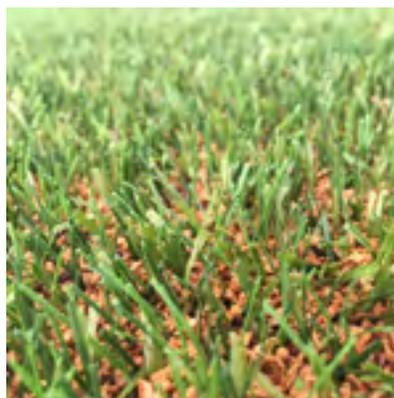
L'utilisation du liège comme matériau de remplissage (infill) pour gazon synthétique est connue, une solution extrêmement favorable en raison des nombreuses propriétés du matériau, comme sa faible densité (propriétés d'isolation avec une faible absorption thermique en cas d'exposition à la lumière), sa grande élasticité, sa résistance élevée et faible usure, sa grande résistance au feu, un cycle de vie intéressant, l'absence de toxicité pour l'environnement et une odeur neutre.
