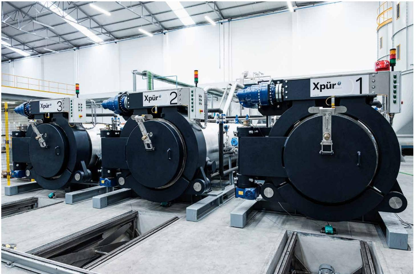
Et si les jours du TCA et d'autres déviations organoleptiques étaient comptés ? Telle semble être la promesse (tenue) par Xpür®, la nouvelle technologie de fluide supercritique développée par Amorim Cork, qui marque un avant et un après dans la lutte contre les composés volatils indésirables qui affectent les vins.
