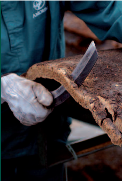
Seleção visual das pranchas de cortiça Graças ao trabalho de Colaboradores altamente especializados, a cortiça é analisada – prancha a prancha – maximizando a sua rentabilidade.
