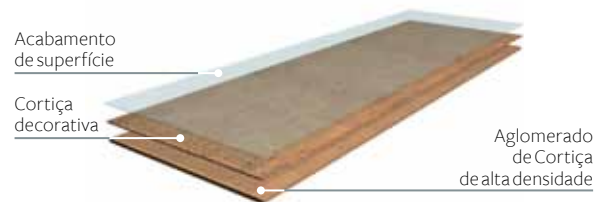
Imagem 9 – Constituição de um ladrilho de piso em cortiça para colar
