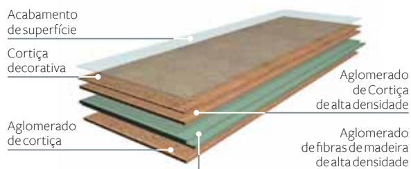
Imagem 8 – Constituição de um painel de piso flutuante em cortiça
